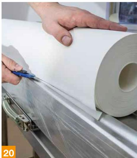
Schneiden Sie den Wandbelag am hinteren Ende des Gerätes ab, bevor dieser zwischen Führungsrolle und Geräterückseite in das Gerät hineinläuft. Ziehen Sie den Wandbelag vollständig aus dem Gerät heraus.
