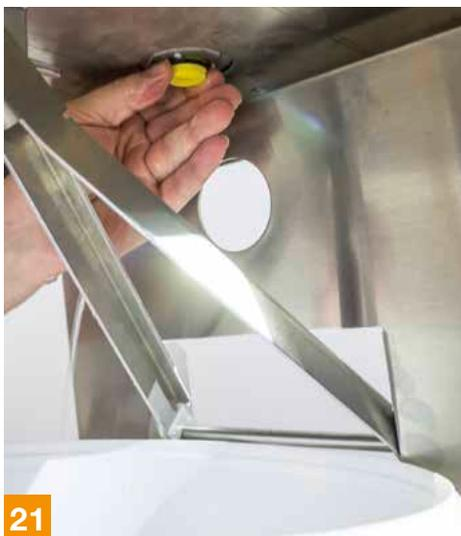
Stellen Sie ein ausreichend großes Gefäß unter den Ablaufstopfen an der Unterseite des Gerätes. Öffnen Sie den Ablaufstopfen (verwenden Sie hierfür eventuell einen Malerspachtel) und lassen Sie das Gerät leerlaufen.
