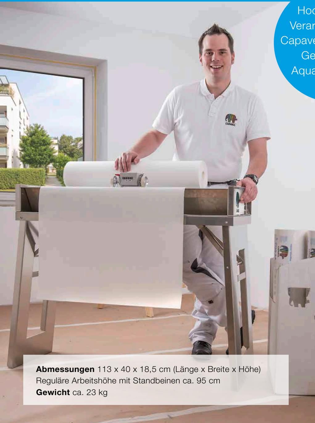
Die **Capaver® Aqua-Tauchwanne** ermöglicht eine hochrationelle Verarbeitung aller Capaver® AquaAktiv-Gewebe und -Vliese. Die Tauchwanne ist mit einer Abrollvorrichtung (mit Meterzähler) für Gewebe- und Vliesrollen sowie einem Mikrofaserabstreifer für die definierte Benetzung mit Wasser ausgestattet. Nach Abschluss der Arbeiten wird das Restwasser problemlos durch das Öffnen des Ablaufstopfens in einen Eimer oder Abguss entsorgt.
